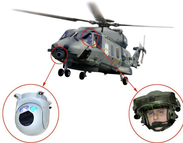
Figure 1 : Hélicoptère NH90 équipé du système de vision en réalité augmentée
