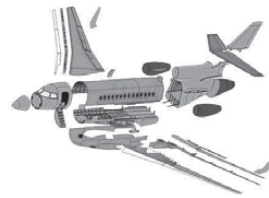
Figure 2 : FALCON 7X et vue éclatée des différents sous-ensembles d'un FALCON 7X
